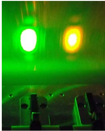
図1 小型モジュールからの波長561nm、594nmのレーザー発光の様子
