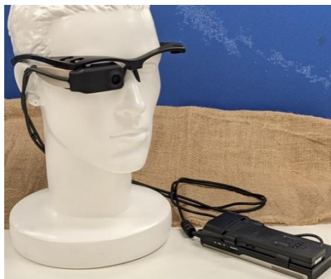
図 アクセサリーカメラ RD2CAM と取り付けイメージ図。カメラ映像が網膜に投影されます。
